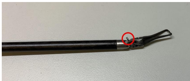
Abbildung F: Gerissener Nickbewegungs-Seilzug
