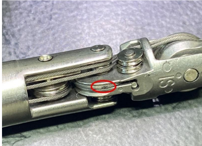
Abbildung G: Ausgefranster Nickbewegungs-Seilzug
