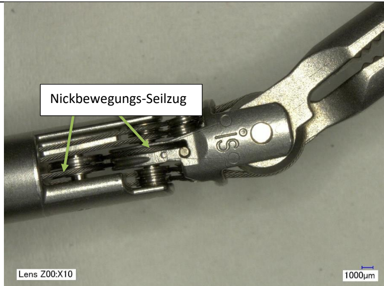
Abbildung B: 10-fach Vergrößerung eines Beispiels für zwei intakte Nickbewegungs-Seilzüge in einem da Vinci Xi Small Graptor (Greifretraktor, klein)
