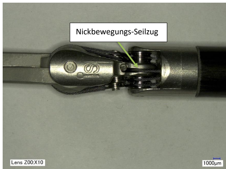
Abbildung A: 10-fache Vergrößerung eines Beispiels für einen intakten Nickbewegungs-Seilzugs in einer da Vinci Xi-Tenaculum-Fasszange
