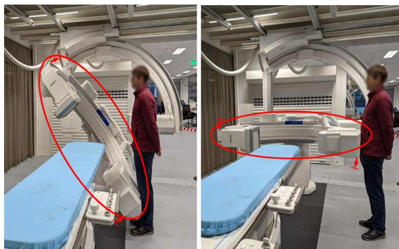
Figura 3: Movimenti imprevisti dell'arco a C (cerchio rosso) dovuti alla rottura del bullone di aggancio del motore per la rotazione intorno all'asse orizzontale.
