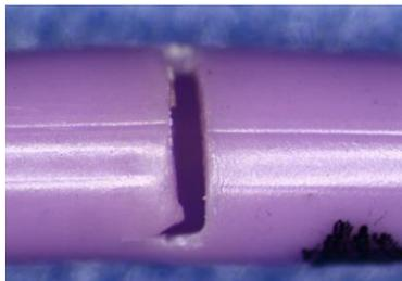
**Figure 1 : Exemple de fissure transversale/circonférentielle dans le corps du cathéter**
