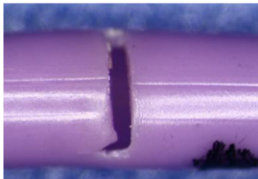
Abb. 1: Beispiel eines transversalen/umlaufenden Risses im Katheterkörper
