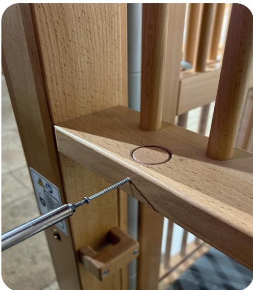
7. Verschrauben Sie den Stopfen mit den beiliegenden Schrauben ohne Vorbohren.
