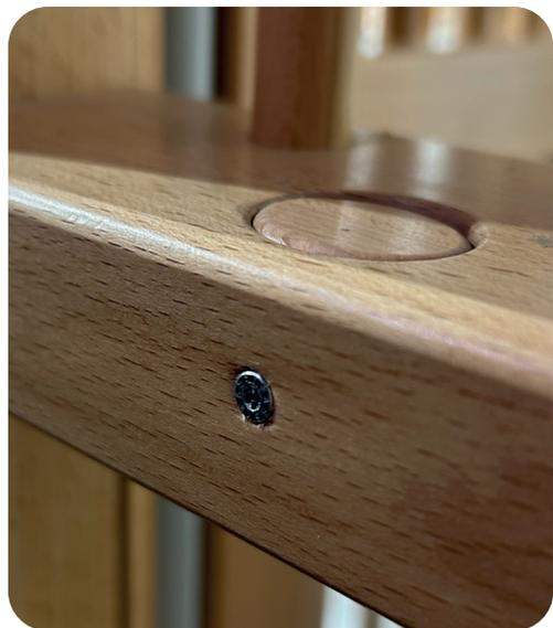
8. Ziehen Sie die Schraube soweit an, bis der Kopf bündig mit der Oberfläche abschließt.
