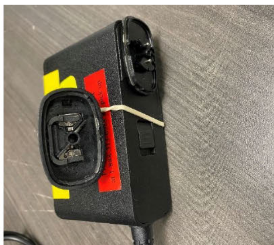
Figura 2: Spina di ingresso danneggiata
