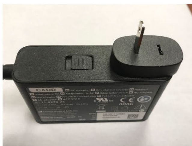
Figura 3: Adattatore AC con polo mancante
