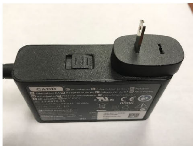
Figure 3: Adaptateur secteur présentant une broche manquante
