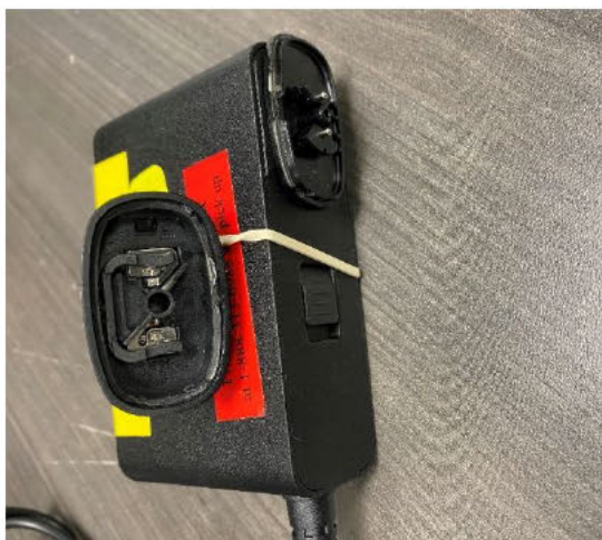
Figure 2: Fiche d'entrée endommagée
