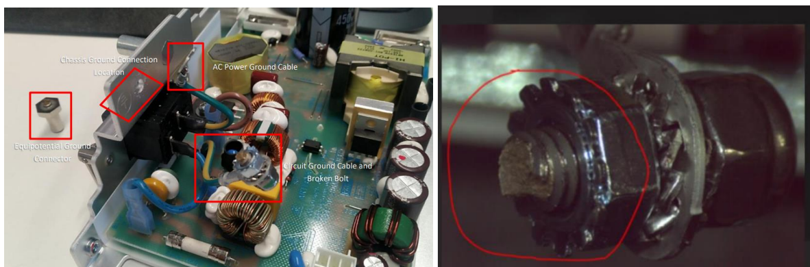
Figura 1. Telaio dell'alimentatore e circuito con fili della messa a terra scollegati e bullone della messa a terra rotto
