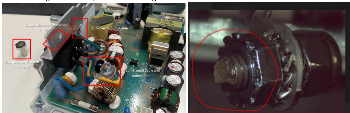
Abbildung 1. Gehäuse des Netzteils und Stromkreis mit getrennten Erdungskabeln und abgebrochener Erdungsschraube
