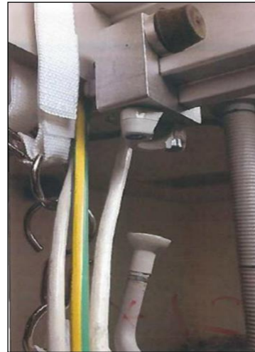
Boîtier de palier en plastique cassé Cela peut entraîner la chute du flexible de câble
