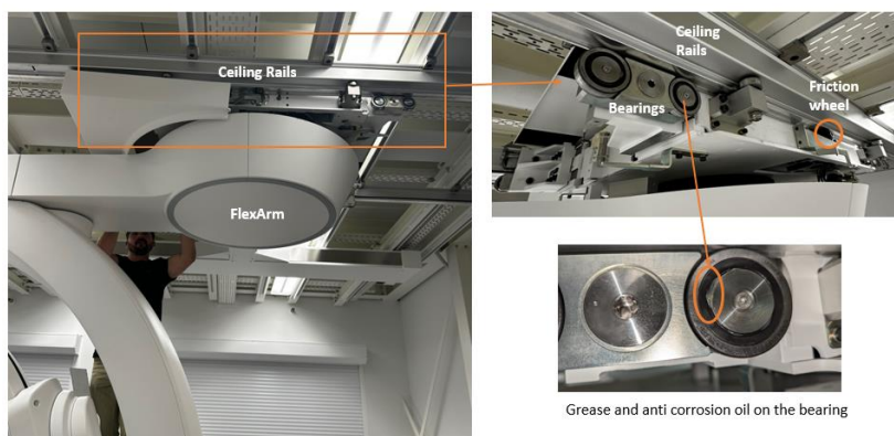
Figure 2. Présentation des éléments du statif FlexArm et identification du problème
