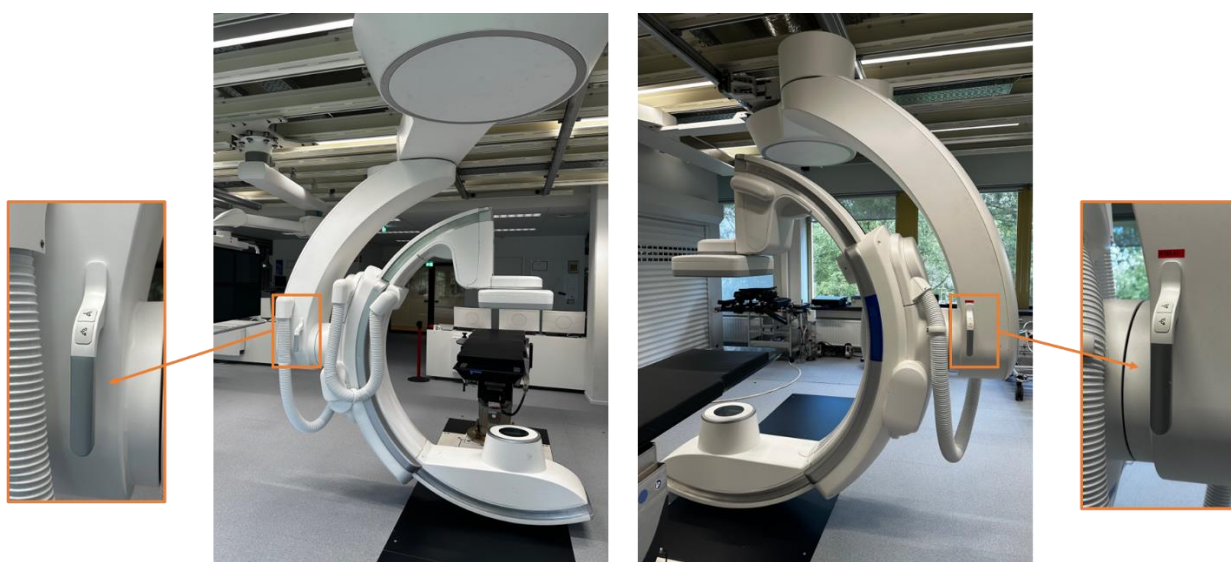
Figure 3 : poignée avec commandes de frein des deux côtés du statif FlexArm
