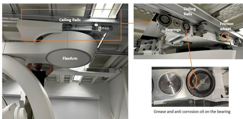
Abbildung 2: Überblick über die Elemente des FlexArm Stativs und Problemidentifizierung
