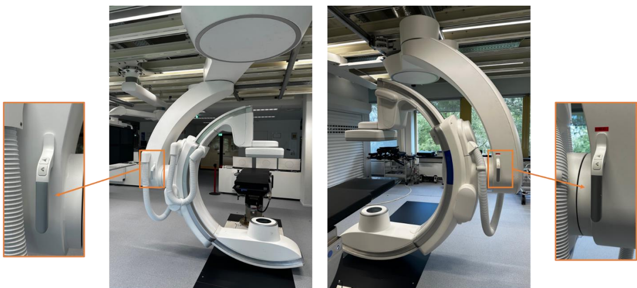
Abbildung 3: Handgriff mit Bremssteuerungen auf beiden Seiten des FlexArm Stativs
