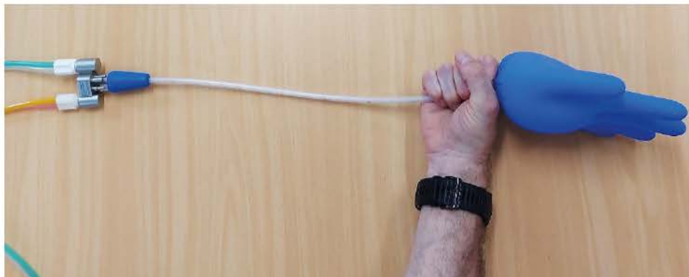
Abbildung 6: Drucktest. Beatmung läuft. Handschuh bläst sich auf.
