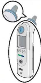
**NOTA** Posizionare una nuova copertura della sonda sul termometro prima della pulizia.
