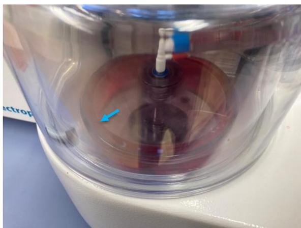
**Abb. 1 – Mäßig gefüllte Kammer.** Die Kammer rotiert, der Füllstand ist sicher für weitere Auffüllschritte. Dieses Bild zeigt den erwarteten Füllstand am Ende von Status 10428 im Modul „Bulkprodukt konzentrieren“ (blauer Pfeil zeigt auf die Grenze zwischen Flüssigkeit und Luft) der LP-TCR $\alpha$  CD19-Depletion. Falls Sie unsicher sind, wenden Sie sich an den technischen Support.
