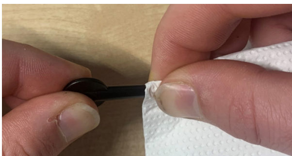
Fig. 7 – Position du chiffon en microfibre lorsque le tube LDPE est maintenu (852652)
