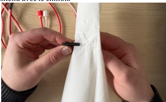
Fig. 6 – Saisie du tube LDPE (852652) à l'aide d'un chiffon en microfibre/d'une lingette désinfectante
