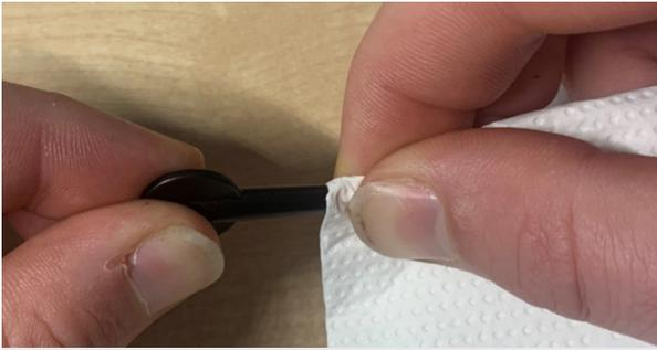
**Abb. 7 – Position des Fasertuchs beim Halten des LDPE-Schlauchs (852652)**
