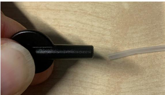
**Abb. 12 – Herausziehen des LDPE-Schlauchs**
