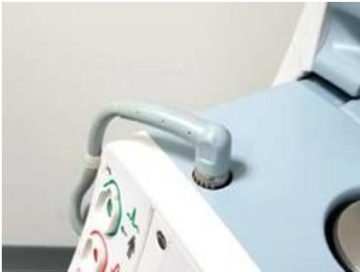
Connexion du cordon spiralé de la nouvelle console :
