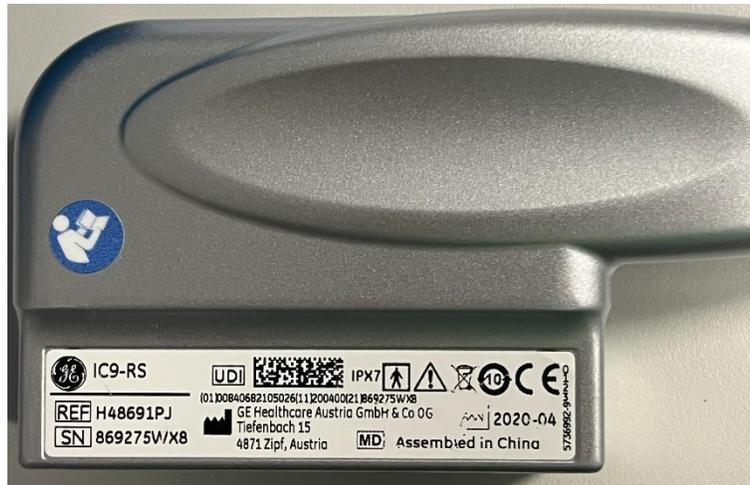
Figura 4. Esempio di targhetta identificativa – visualizzazione del tipo di sonda (IC9-RS) e del numero di serie (SN).
