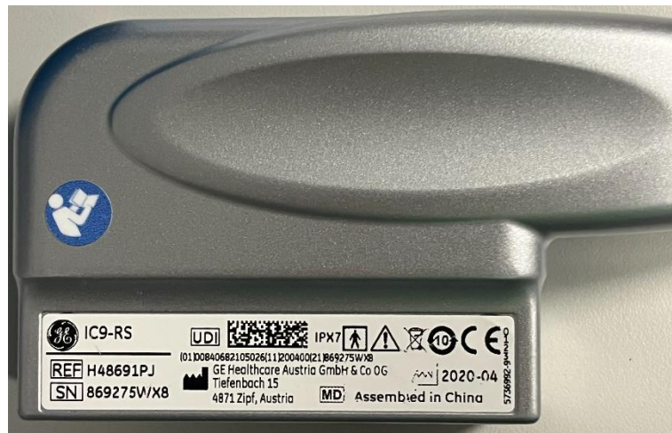
Figure 4. Exemple de plaque signalétique – affichant le type de la sonde (IC9-RS) et le numéro de série (SN).
