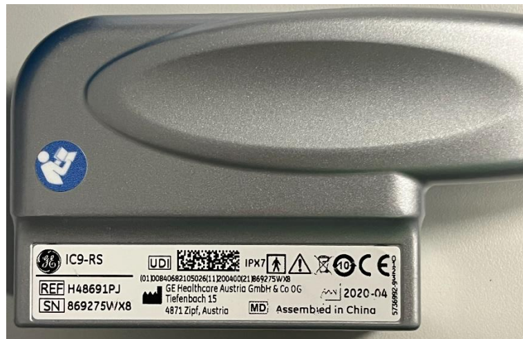
Abbildung 4. Beispiel für ein Typenschild - mit Anzeige des Sondentyps (IC9-RS) und der Seriennummer (SN).
