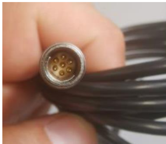
Abbildung 5: Konnektor des HL 40 Blasensensors (Artikel Nr. 701065317)
