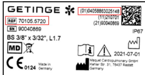
Abbildung 3: Etikett mit falscher UDI 04058863025148
