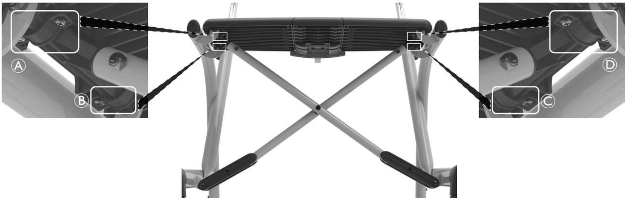
**i** \*Alternativ zu Schritt 1., können Sie die vier **Innenschrauben** (1x**A**, 1x**B**, 1x**C** und 1x**D**) entfernen und die äußeren Schrauben nur lösen, so dass Sie die Halterungen um 90 ° nach außen drehen können. Dann können Sie den Sitz vom Rahmen des Rollators abnehmen. Bei dieser Vorgehensweise bleiben die vier Halterungen am Sitz befestigt, so dass der Sitz nach der Montage der neuen Kreuzstrebe leichter wieder am Rahmen befestigt werden kann.
