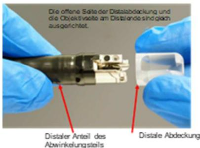
Abbildung 1: Ausrichten von Distalabdeckung und Endoskopspitze
