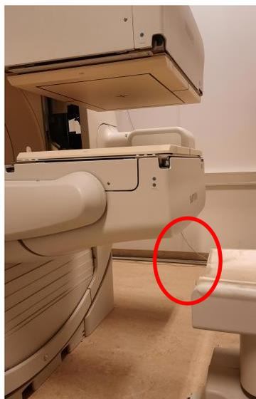
Philips a reçu un (1) rapport signalant un événement indésirable lié à ce problème. Dans ce cas signalé, l’opérateur a positionné un patient sur le support patient et déclenché le mouvement préprogrammé du corps entier. Alors que le support patient et les détecteurs étaient en mouvement, le patient a allongé sa jambe en raison d’une crampe. Il a alors étendu son pied qui s’est coincé entre le support patient et le détecteur. Le patient a été victime d’une fracture du pied.
