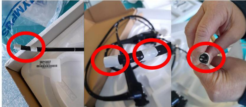
Il nastro bianco viene utilizzato durante la procedura di riparazione per proteggere le parti sensibili dell'endoscopio da eventuali danni (graffi e ammaccature). Deve essere rimosso durante il controllo finale prima di essere restituito al cliente per l'uso sul paziente. L'endoscopio non deve essere utilizzato su un paziente con questo nastro di manutenzione bianco attaccato.
