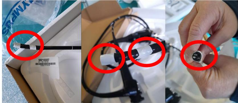
Ce ruban blanc est utilisé au cours du processus de réparation afin de protéger les parties sensibles de l'endoscope contre les dommages (rayures et chocs). Il doit être retiré au cours de l'inspection finale avant le retour du produit au client et donc avant l'utilisation du produit sur les patients. L'endoscope n'est pas destiné à être utilisé sur un patient si ce ruban blanc de service est attaché.
