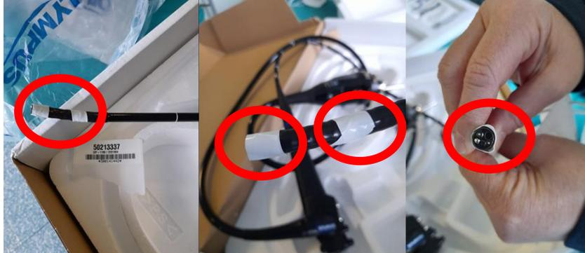
Dieses weiße Klebeband wird während der Reparatur verwendet, um empfindliche Teile des Endoskops vor Beschädigungen (Kratzern und Dellen) zu schützen. Es muss bei der abschließenden Kontrolle entfernt werden, bevor das Gerät zum Einsatz am Patienten an den Kunden zurückgesendet wird. Das Endoskop darf auf keinen Fall bei einem Patienten verwendet werden, wenn dieses weiße Schutzklebeband noch angebracht ist.
