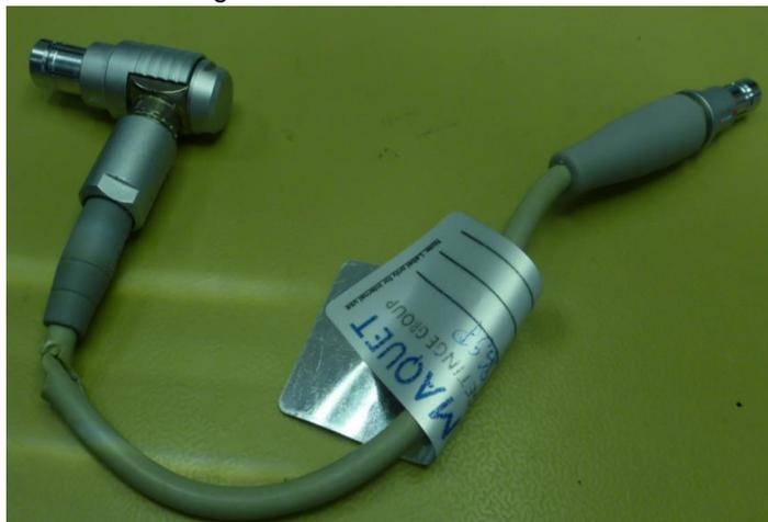
Abbildung 2: Beispiel einer gerissenen Kabelisolierung aus der Praxis
