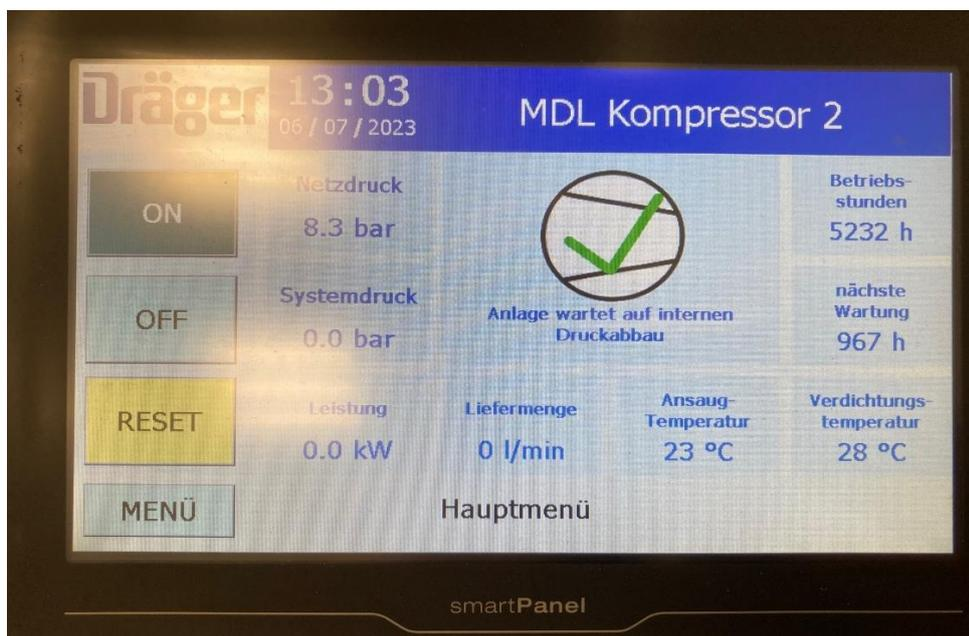
Verbleibt der Kompressor in diesem Betriebszustand länger als 5 Minuten, muss der Kompressor neu gestartet werden.
