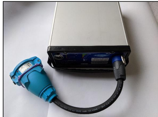
Figura 7: batteria NiMH con adattatore CC
