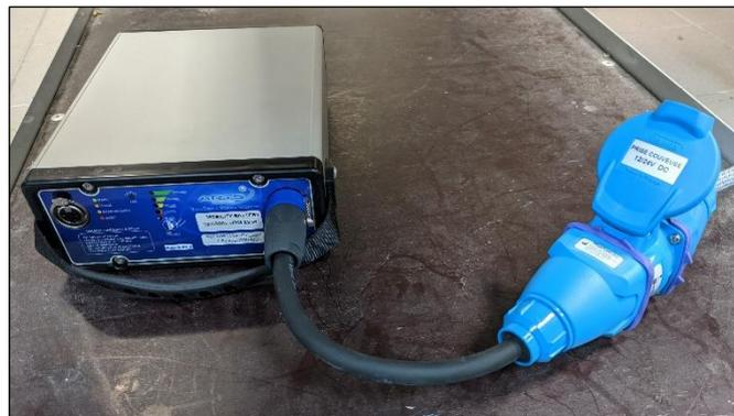
Abbildung 8: Mit dem NITE verbundener NiMH Akku
