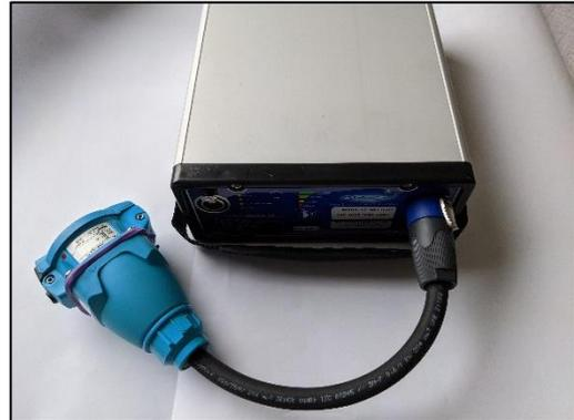
Abbildung 7: NiMH Akku mit Gleichstrom-Adapter
