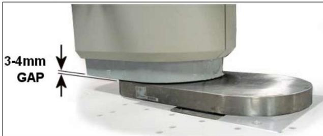
Wenn der Abstand zwischen der Sockelabdeckung und dem Boden nicht den oben genannten Anforderungen entspricht, stellen Sie die Sockelabdeckung gemäß den Reparaturanweisungen ein.
