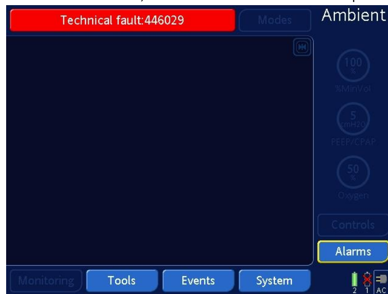
Figura 1: sul display è indicata la condizione Ambient ed è visualizzato un messaggio su sfondo rosso con il numero del guasto tecnico (immagine di esempio, il numero di guasto tecnico visualizzato può essere diverso)
