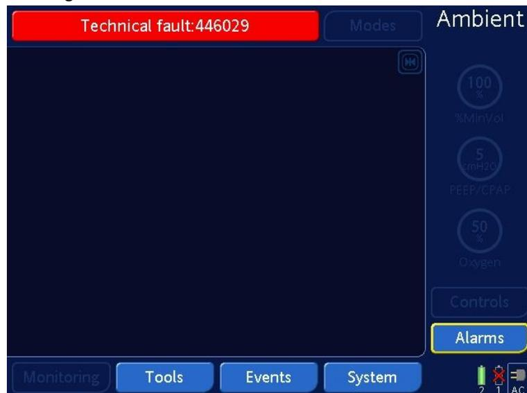
Abbildung 1: Auf dem Bildschirm werden der „Ambient“-Modus sowie eine rot hinterlegte Meldung mit einer Nummer für den technischen Fehler angezeigt (Beispiel; es kann auch eine andere Nummer für den technischen Fehler angezeigt werden).
