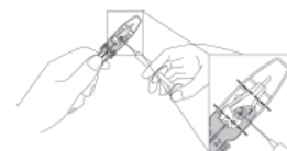
Fig. 5. Étape 1 : injecter le produit viscoélastique
