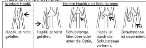
Abb. 11: Schritt 5 – Bei falscher Position nicht fortfahren
