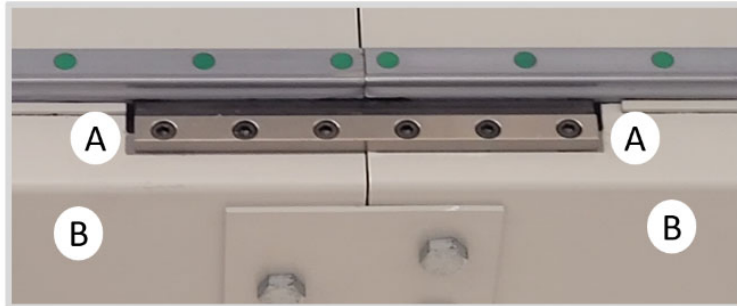
Abbildung 6. Stellen mit möglicher Rissbildung
