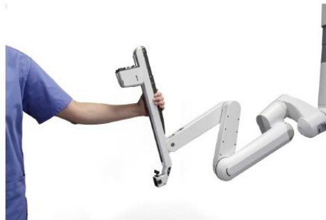
Abbildung 2: Abbildung zeigt, wie der USM/Arm bei der manuellen Positionierung richtig gehalten wird.
