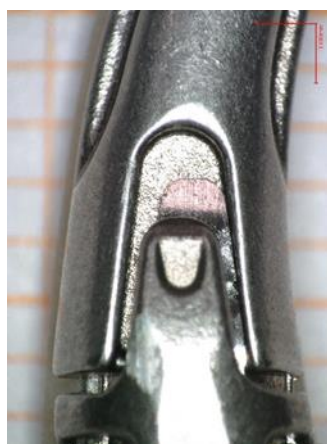
Figure 2 : ressort décalé dans la cage du mors
