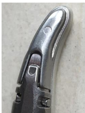
Figure 1 : ressort bien fixé dans la cage du mors (état désiré)
