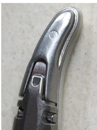
Abbildung 1: Die Feder ist korrekt im Maulteilgehäuse befestigt (Sollzustand)
