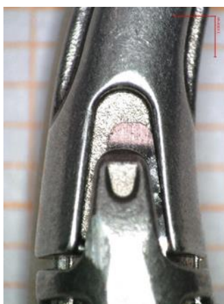
Abbildung 2: Verschobene Feder im Maulteilgehäuse
