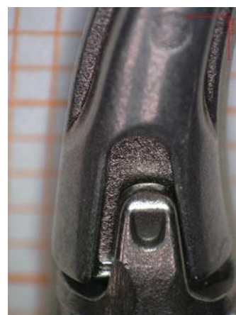
Abbildung 3: Die Feder ist herausgefallen
