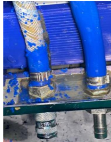
Abbildung 2: Verschlossener vs. intakter blauer Schlauch
