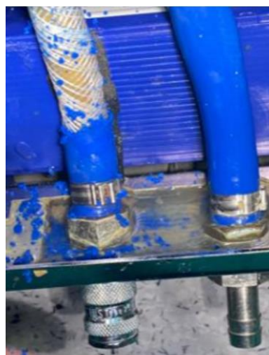
Abbildung 2: Verschlossener vs. intakter blauer Schlauch
