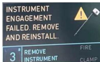
Figura 1 (messaggio sullo schermo come visualizzato sul touchscreen del Carrello lato visione, "Innesto strumento non riuscito. Rimuovere e reinstallare")
