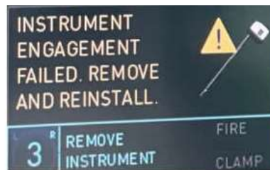
Figure 1 (Message affiché sur l'écran tactile du chariot d'imagerie latéral : « Échec d'enclenchement de l'instrument. Retirer et réinstaller ».)
