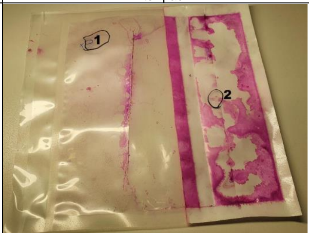
Exemple de fissure sur une coque d'emballage Intellipack
