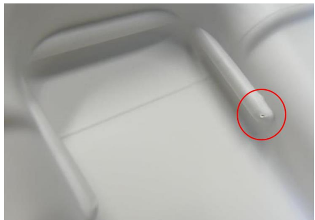
Exemple de fissure sur une coque d'emballage Intellipack
