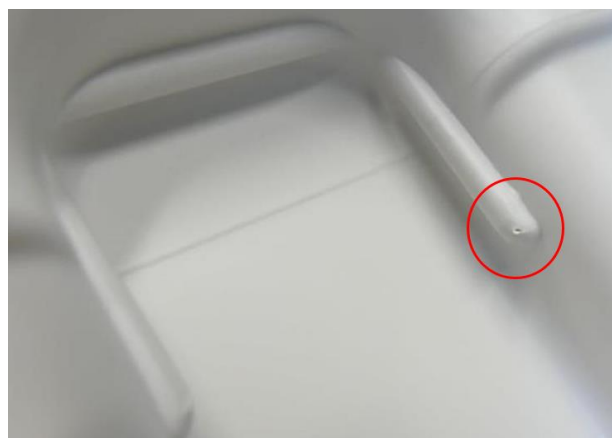
Exemple de fissure sur le bac de conditionnement intellipack
