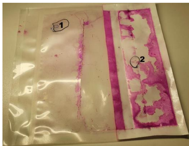
Exemple de fissure sur le bac de conditionnement intellipack
