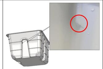
Bereich der Intellipack Verpackungsschale, in dem der Fehler entdeckt wurde mit einem Riss
