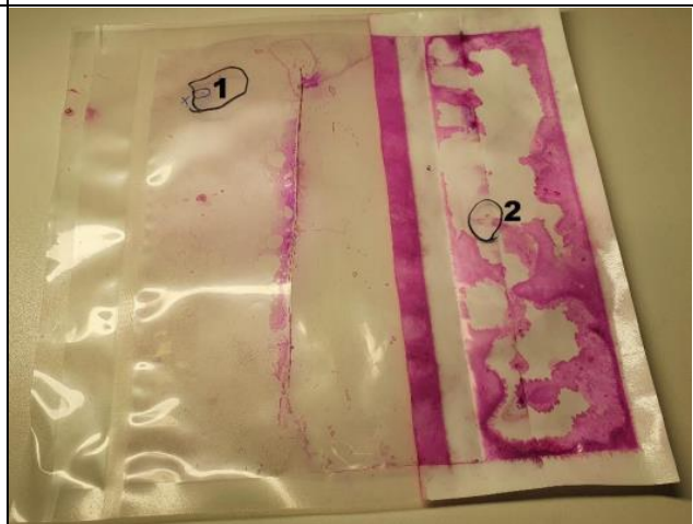
Rissbeispiel an einer Intellipack Verpackungsschale
