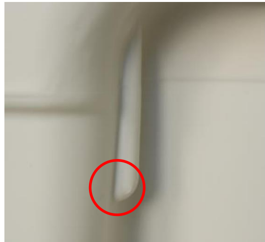
Weißer Spannungsspuren auf der Intellipack Verpackungsschale
